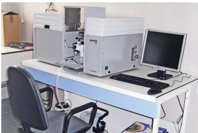
Stația de la Mărtinești: spectrofotometru cu absorbție atomică, unul dintre echipamentele cu care a fost dotat laboratorul stației
